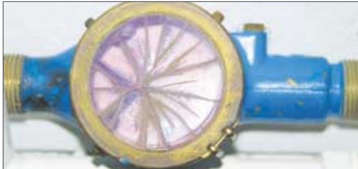
Defekter Glasdeckel eines Wasserzählers nach Minusgraden.
