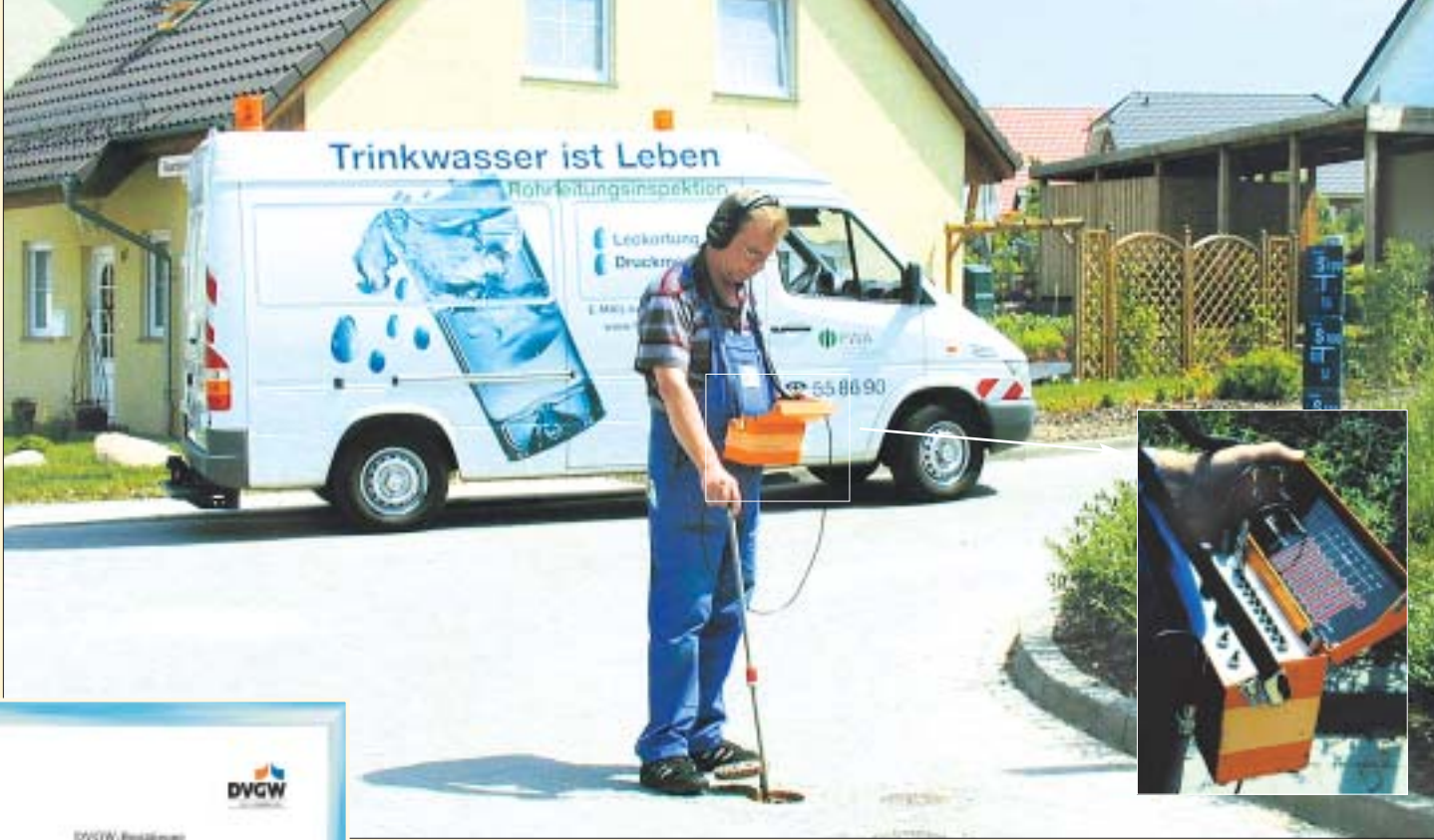
Dieter Brehmer „lauscht“ am Leitungsnetz, um eventuelle Rohrschäden frühzeitig aufspüren zu können. Sein „verlängertes Ohr“ (Foto oben rechts).
