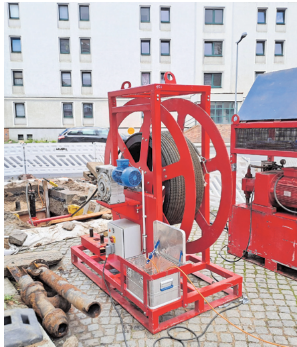
Beim sogenannten Berstlining-Verfahren werden, wie hier in der Dresdener Straße, neue Trinkwasserleitungen weitgehend ohne Graben in alte Leitungen eingezogen. Fotos (2): FWA
